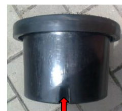
Zdj. nr 6. Wycięcie w pokrywie
