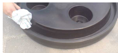
Zdjęcie nr 26. Czyszczenie rowka
