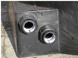
Zdjęcie nr 8. Złączki przygotowane w zakładzie produkcyjnym
