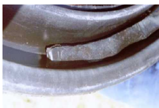
Zdjęcie nr 28. Uszczelka UP w rowku pokrywy
