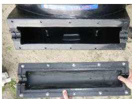
Zdj. nr 3,4. Odkręcanie i zdjęcie pokrywy bocznej
