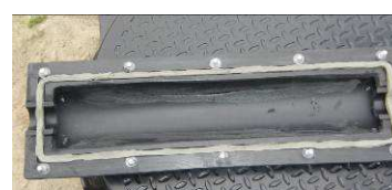
Zdj. nr 12. Pokrywa boczna z uszczelką
