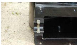
Zdj. nr 17, 18, 19. Zakładanie uszczelki UP w rowki i widok uszczelki w korpusie
