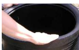
Zdj. nr 38 Smarowanie środkiem poślizgowym
