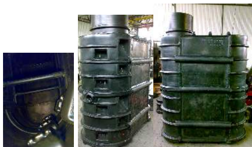
Zdj. nr 48 Komora wodomierzowa 1000x2000
