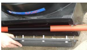
Zdj. nr 21. Założenie pokrywy bocznej
