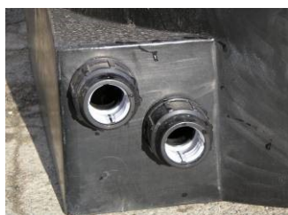
Zdjęcie nr 8. Złączki przygotowane w zakładzie produkcyjnym
