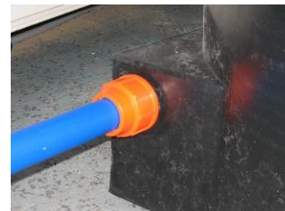
Zdjęcie nr 10. Rura połączona z korpusem za pomocą złączki skręcanej
