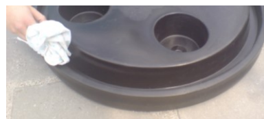
Zdjęcie nr 29. Czyszczenie rowka
