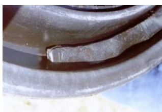
Zdjęcie nr 31. Uszczelka UP w rowku pokrywy
