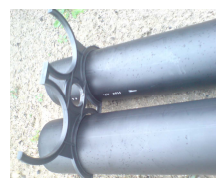
Zdjęcie nr 3. Zabudowa przekładki w zestawie rur
