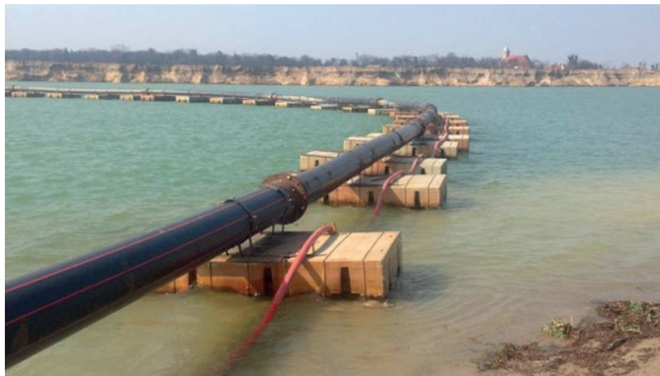
Przykładowe możliwości zastosowania pojedynczych pływaków serii W pod rurę do hydrotransportu.
